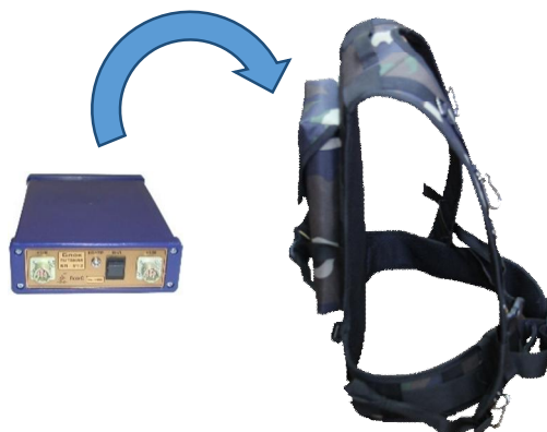
Рис. 2.3 - Размещение блока питания БП-9/12 в ременно-плечевой системе
